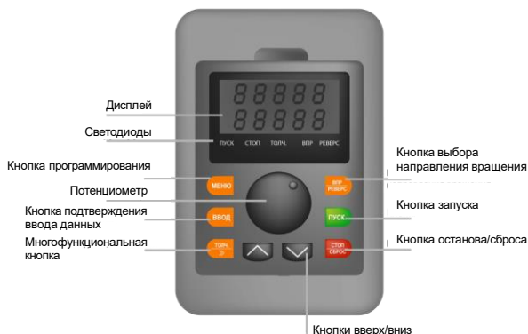
Рис. 5.1 – Функции кнопок и светодиодов панели управления LCI
